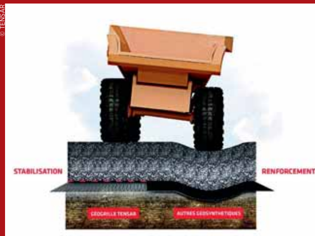
Construction sur sol meuble avec la géo grille TriAx
